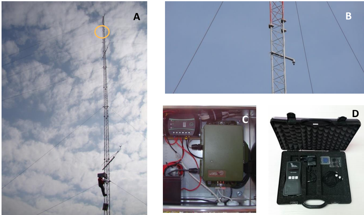
Slika 3. Oprema za praćenje aktivnosti šišmiša na lokaciji planirane VE Dazlina: A – mjerni stup i označen položaj mikrofona, B – mikrofona uz mjerni stup na istraživanoj lokaciji, C – ultrazvučni detektor SM4BAT FS Song Meter za kontinuirano praćenje, D – Elekon Batlogger M za periodično praćenje (Foto: G. Rnjak, D. Rnjak, N. Hanžek)
